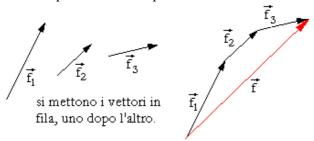
Si preferisce ricavare il risultante disponendo i tre vettori in fila (anche qui non importa l'ordine con cui si prendono), in modo che l'inizio di ogni vettore coincida con la punta del precedente.
