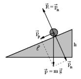
$\overrightarrow{p_p}$  parallela al piano inclinato, ed una  $\overrightarrow{p_n}$  normale al piano inclinato.
