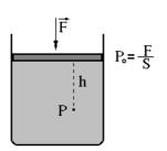
Si abbia un recipiente cilindrico contenente un liquido, coperto da un pistone, ed applichiamo sul pistone una forza F.
