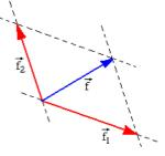
Si può anche eseguire l'operazione contraria: un vettore  $\vec{f}$  può essere scomposto in due componenti  $\vec{f_1}$  e  $\vec{f_2}$  applicando la regola del parallelogramma. Si scelgono due rette arbitrarie passanti per il punto di applicazione di  $\vec{f}$ , e si costruisce il parallelogramma.
