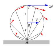
Se un corpo rigido oltre ad una rotazione è sottoposto anche ad una traslazione, per esempio una ruota che rotola su un piano, allora occorre integrare i concetti precedenti nel modo seguente.
