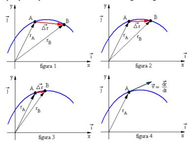
Consideriamo il punto materiale nelle due posizioni A e B (figura 1). I vettori spostamento sono indicati dalle due frecce  $\overrightarrow{r_A}$  e  $\overrightarrow{r_B}$ .
