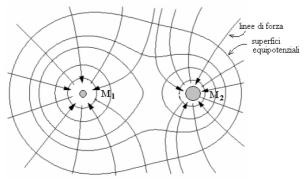
Una proprietà delle superfici equipotenziali consiste nel fatto che le linee di forza sono sempre perpendicolari alle superfici equipotenziali nel punto in cui le attraversano (come si può controllare nella figura).
