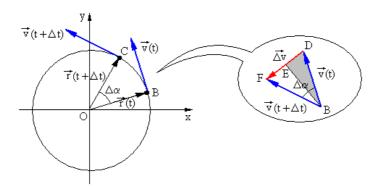
I due vettori velocità (uguali in modulo ma orientati diversamente) possono essere applicati in uno stesso punto formando così un triangolo isoscele con angolo al vertice di ampiezza  $\Delta\alpha$ .
