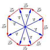
permetta di calcolare questa accelerazione centripeta.
