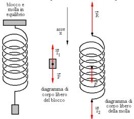
$\vec{P}$  è il peso del blocco,  $\vec{T}_1$  è la tensione che l'estremità inferiore della molla esplica sul blocco.  $\vec{T}_2$  è la tensione che il blocco esercita sulla molla,  $\vec{p}$  è il peso della molla, ed  $\vec{R}$  è la reazione vincolare esplicata dal soffitto.
