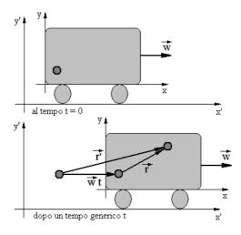
Mettiamo ora a confronto le velocità e le accelerazioni misurate da due osservatori posti in due sistemi di riferimento che si muovono fra loro con velocità costante.
