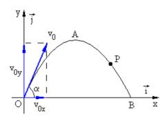
Si abbia un corpo (per esempio un proiettile, trattato sempre come se fosse un punto) lanciato in aria con una velocità iniziale v<sub>0</sub> e con un certo angolo α (detto **alzo**) rispetto alla direzione orizzontale.
