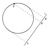
La proiezione del punto P sulla retta r, è un punto P' che si muove avanti ed indietro con moto armonico lungo il segmento AB
