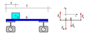
Una sbarra omogenea di ferro poggia su due dinamometri posti alle due estremità. La sbarra è lunga 2 metri e pesa 80 Newton. Su di essa, alla distanza di 50 cm da una estremità è posto un blocco il cui peso è di 120 Newton.
