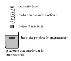
Nel paragrafo 5 abbiamo evidenziato il fatto che nel moto armonico l'energia potenziale (per esempio di una molla) si trasforma ciclicamente in cinetica energia viceversa, che e la. somma delle due energie è costante.
