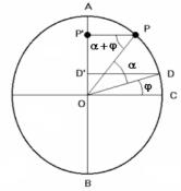
si muove con moto armonico, nella sua forma più generalizzata, mentre la (11-1) ne costituisce un caso particolare (quello in cui nell'istante di partenza del cronometro, t=0, l'angolo  $\phi$   $\Box$ è nullo e P' si trova in O).
