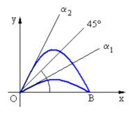
Osservando la figura si può notare che per due angoli simmetrici (per esempio  $\alpha_1$ =45-10=35° e  $\alpha_2$ =45+10=55°) rispetto alla bisettrice, si ottengono due parabole che forniscono la stessa gittata.
