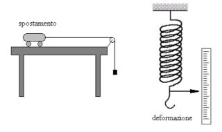
Nella figura a sinistra la caduta di un oggetto pesante trasmette attraverso il filo una forza al carrello che provoca un suo spostamento. Nella figura a destra invece applicando al gancio inferiore un oggetto pesante, la forza produce una deformazione, un allungamento, che può anche essere misurato e fornire un valore della forza stessa.
