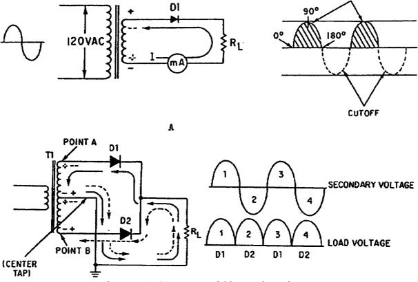
Figure 1-41. Rectifier Circuits.
