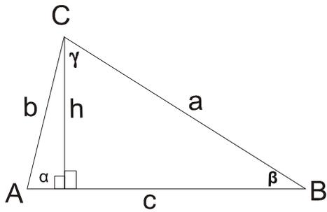
In un triangolo qualunque  $\frac{a}{\text{sen}\alpha} = \frac{b}{\text{sen}\beta} = \frac{c}{\text{sen}\gamma}$ ; per la dimostrazione è sufficiente verificare che  $a \cdot \text{sen}\beta = b \cdot \text{sen}\alpha$ ;  $h = a \cdot \text{sen}\beta = b \cdot \text{sen}\alpha \rightarrow a \cdot \text{sen}\beta = b \cdot \text{sen}\alpha$ .
